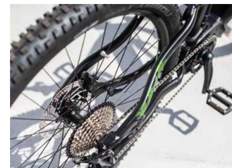
V součtu 285 mm zdvihu vpředu i vzadu si zaslouží čtyřpístkové brzdy, zde model Shimano MT520
