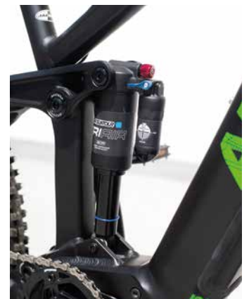
Vzduchový tlumič Suntour je plně nastavitelný, podílí se na jistém pohybu kola v terénu
